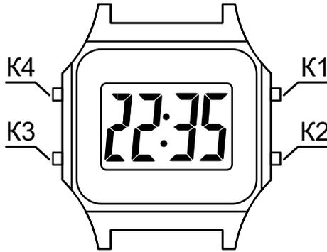
*Внешнее оформление часов может отличаться от изображенного на рисунке; возможно изготовление часов без кнопки K3 и с потайной кнопкой K2.*
